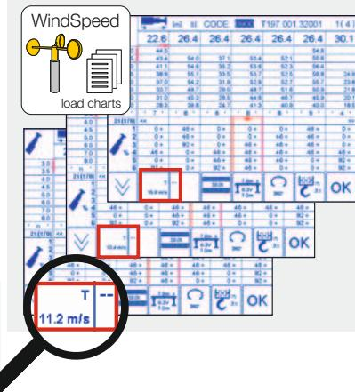
Erhöhte Flexibilität und Sicherheit durch Traglasttabellen mit unterschiedlichen zulässigen Windgeschwindigkeiten.
