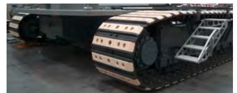
Raupenketten mit Polyamid-Platten • Crawler tracks with polyamide plates • Chenilles avec tuiles polyamides • Cingoli con piastre in poliammide • Orugas con tejas de poliamida • Гусеницы с полиамидными пластинами
